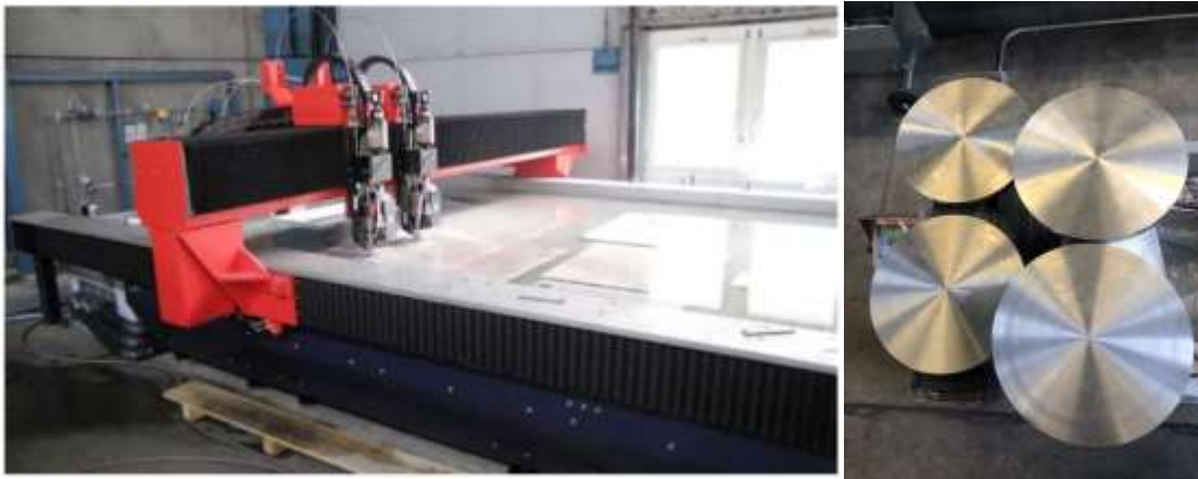
Links: Wasserstrahlschneiden der Rohlinge, rechts: fertige Bauplatten
